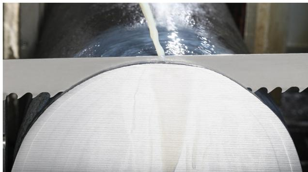
Image 1 : Flexibilité d'utilisation : la nouvelle lame de scie à ruban carbure MARADUR<sup>®</sup> de WIKUS convient également aux machines sans pack carbure. Source : WIKUS-Sägenfabrik
